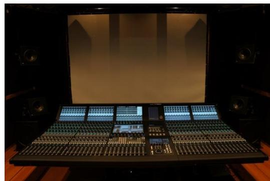
22.2マルチチャンネル音響対応デジタル音声調整卓
