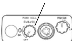
親機と通信中、プッシュスイッチを1秒以上押し込むと、主装置が発信を始めます。
